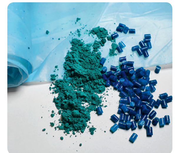
Farbpulver, Farbmasterbatch und Folie auf der Basis von TPS mit Spirulina-Farbstoff Phycocyanin.
