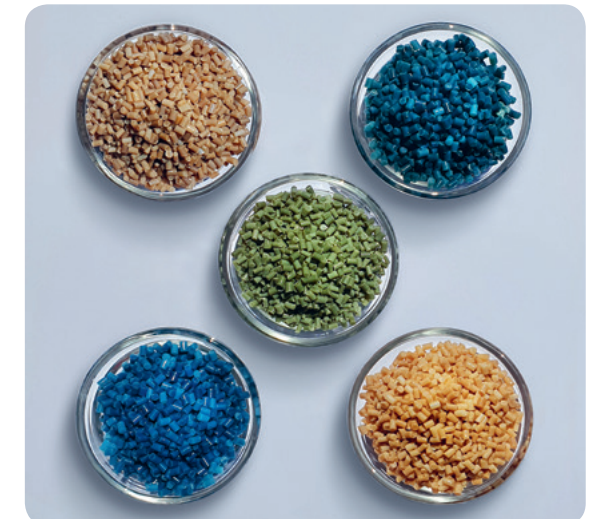
Farbmasterbatches aus Algen (Blau und Türkis), Rhabarberfaser (Beige), Tomatenblatt (Grün) und Tomatenfruchtrester (Orange).
