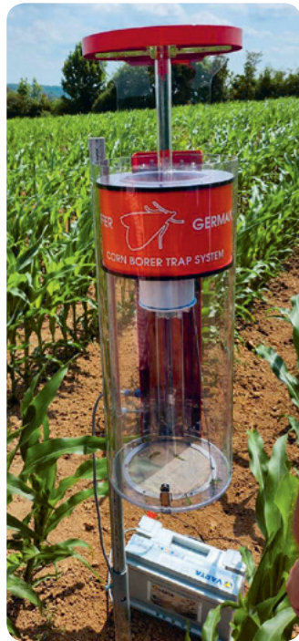
Neuer Prototyp der Insekten-Lebendfalle.
