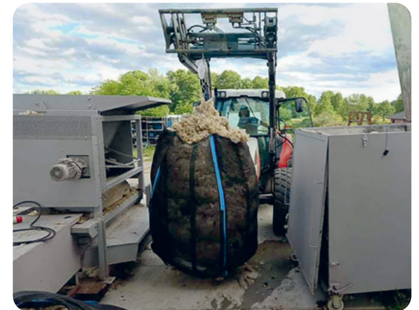
Aufbereitungsanlage, links Wollreißer, rechts Dampfkammer
