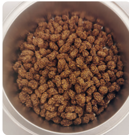
Granulat (Extrudat) aus RPK nach 3-fachem Überzug mit eigenem Verkapselungsmittel als Träger für Biostimulanz
