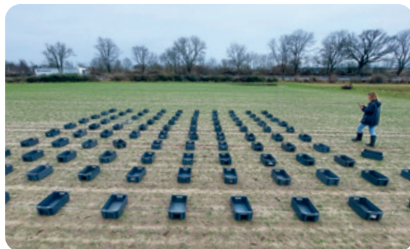
Versuchsaufbau zum Prüfen der Verteilgenauigkeit beim Düngerstreuen.
